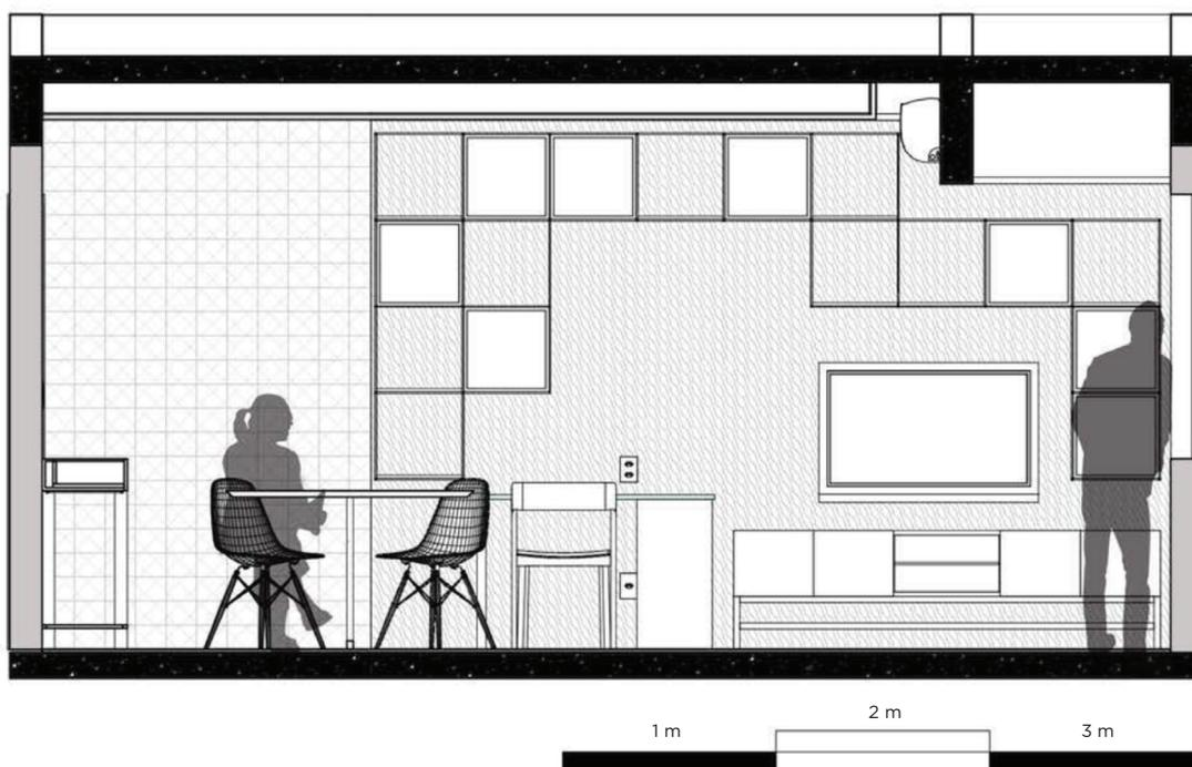
A estante de nichos removíveis, feita de estrutura de vergalhão de 8mm e caixotes e prateleiras de madeira, permite que hajam diversas variações na configuração do móvel, o que gera dinâmicas diferentes para situações diferentes, e permite que o espaço se adeque conforme a necessidade e a vontade de quem o organiza.
